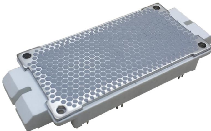
图5 采用丝网印刷术涂敷了导热膏之后的ED3模块底板
